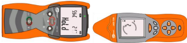
Abb. 5 Positionierung der Sende- und Empfangseinheit während der Synchronisation
